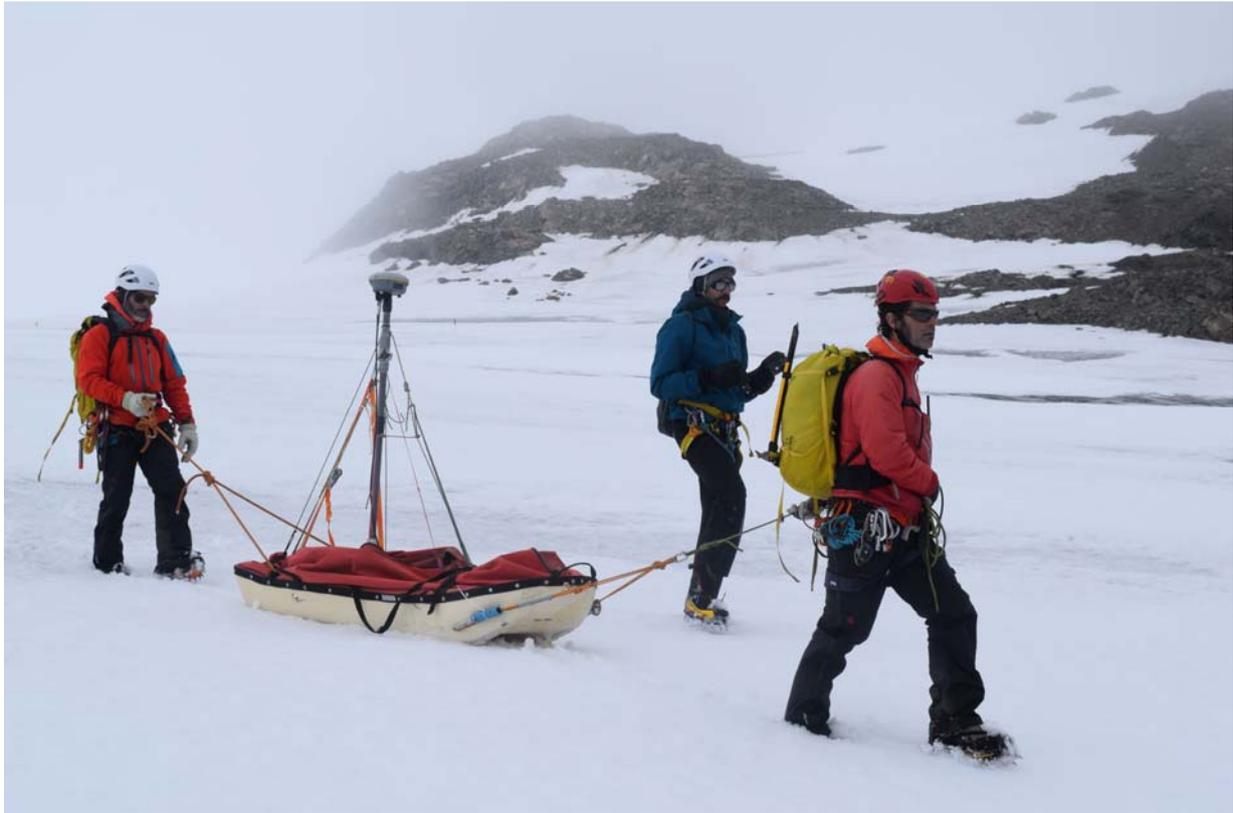
Medidas con georradar de alta frecuencia en el glaciar Johnsons (Isla Livingston, Antártida) para determinar el espesor del hielo en la frontera del glaciar y, con ello, definir con precisión el límite de la superficie ocupada por el glaciar, pues la presencia de nieve impide su determinación visual.
