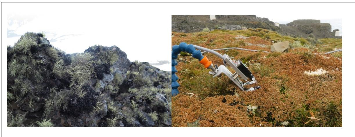
En la imagen de la izquierda se observa una típica comunidad de líquenes antárticos sobre rocas. A la derecha, sensores de fotosíntesis y microclima.
