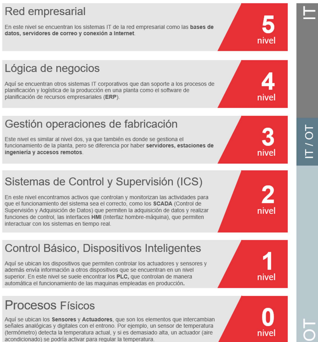
Ilustración 3: Ejemplo de ubicación de los Sistemas IT y OT en una organización (fuente: elaboración propia)
