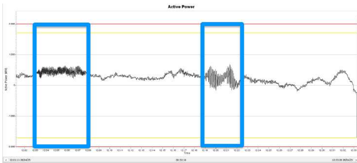
Gráfico 7 Oscilaciones registradas entre las 12:00 y las 12:30 del 28 de abril. Fuente: REE
