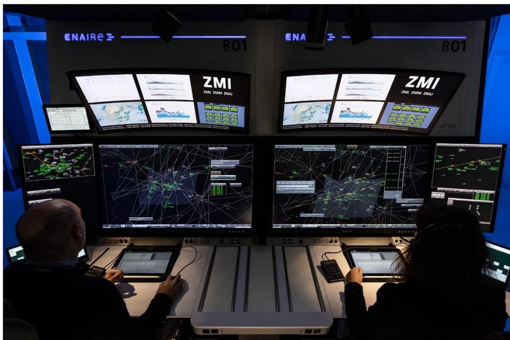
La nueva posición iFOCUCS supone, además, un aumento de la superficie de presentación manteniendo la resolución, permitiendo el trabajo con operativa sin fichas de progresión de vuelo en papel, todo ello con un concepto de diseño ergonómico y eficiente.
